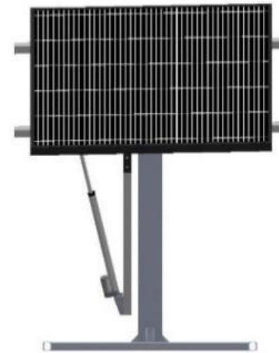
Figura 4. Estructura de Dos ejes de libertad
